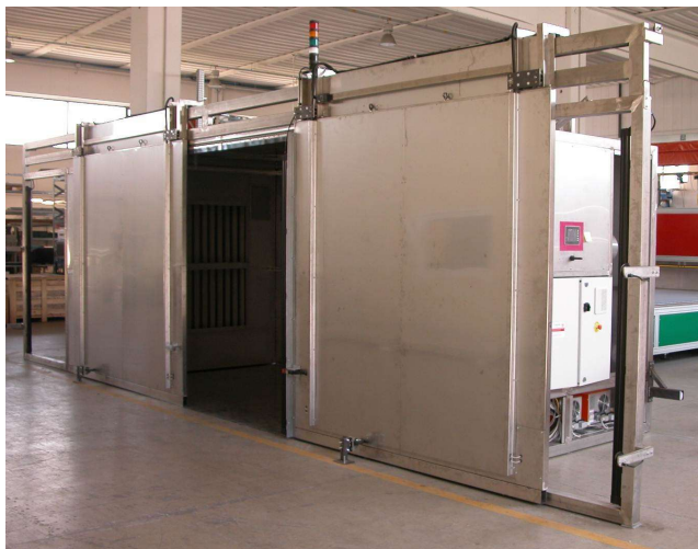
MTT con porte scorrevoli per la lavorazione di alimenti
