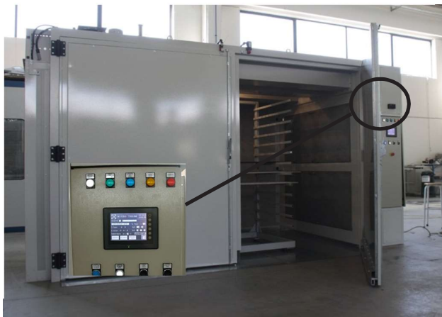
Pannello di comando con touch screen
