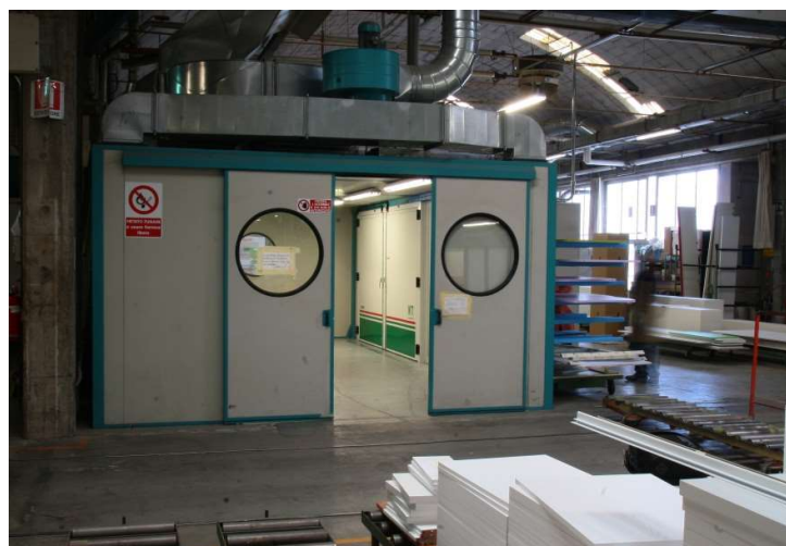
MTT installata in una camera di laccatura per produzioni speciali e just in time nell'arredamento.
