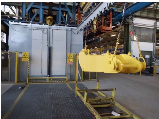
MTT per ciclo automatico per la polimerizzazione della vernice nella produzione di metalli (settore Automotive).
