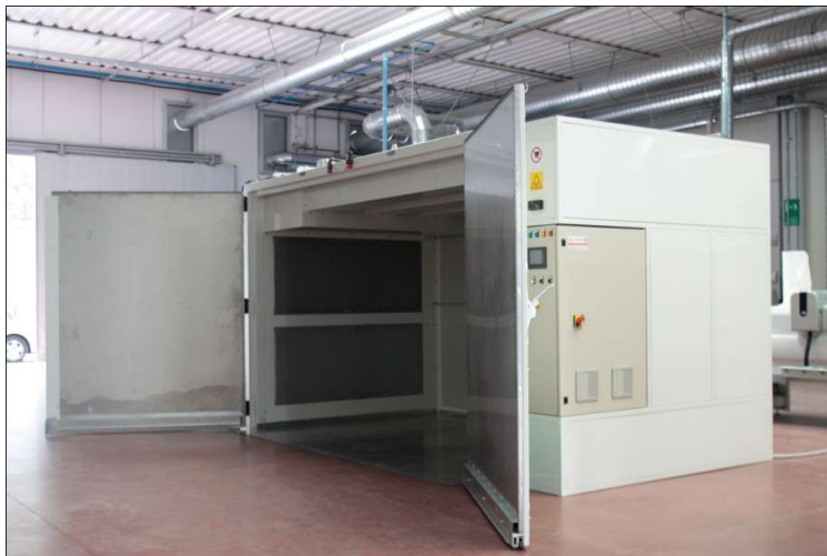
MTT con porte manuali, equipaggiata per trattamenti antitarlo
