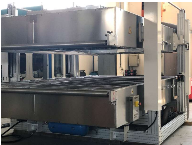
Dettaglio della zona dei rulli di uscita a forno chiuso
